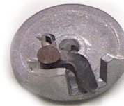
GATILLO JIALING - KENIA (INTERIOR DISCO 6 DIENTES) ALUMINIO (DISCO ARRANQUE CJ50ZC020605)-
