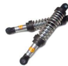
AMORTIGUADOR GARELLI REFORZADO V.A.M JGO - (LARGO ENTRE BUJES 275 MM.)
